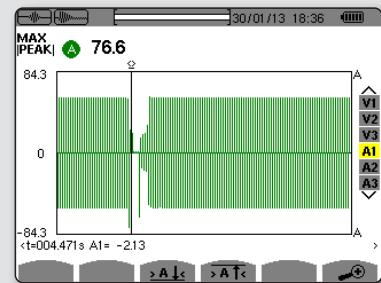
Die Inrush-Messung erfolgt über einen Zeitraum von 10 Minuten. Sobald der Erfassungsmodus feststeht (RMS oder Peak) gewährleistet Qualistar die komplette Erfassung.
